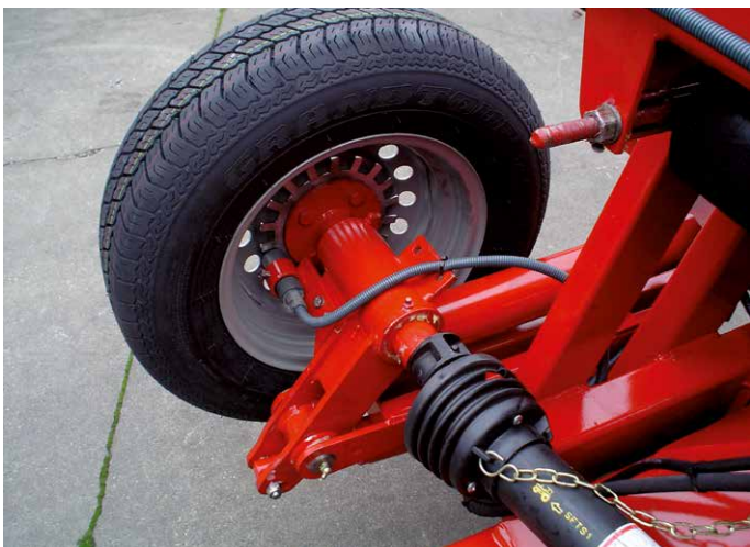
Bodenrad mit Sensor für Flächenmessung.
