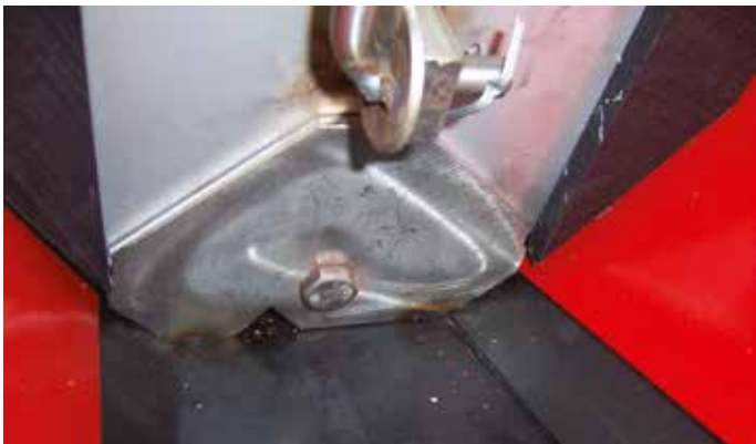
Mikrodoseringsudstyr til særlig små doseringsmængder. Placeres let og uden brug af værktøj under doseringskoddene.
