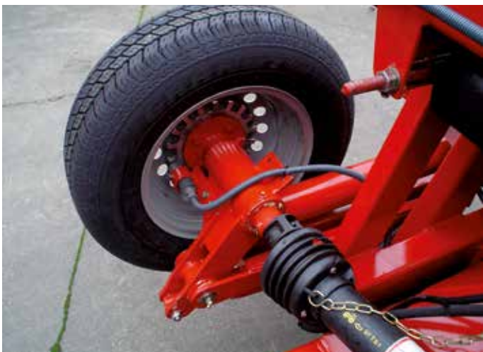
Doseringshjul med tandskive for arealtæller.
