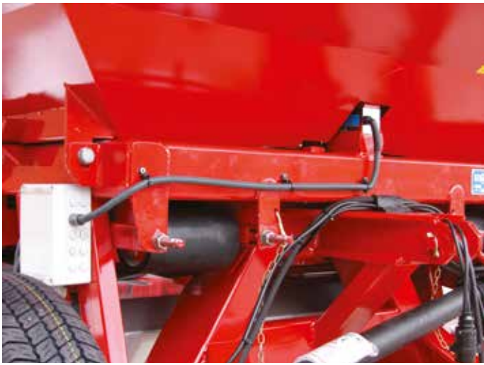
F2W og F2WS modellerne nye og robuste opbyggede ramme med den indbyggede vejecelle, sikrer en stabil og ensartet vejning under alle forhold.
