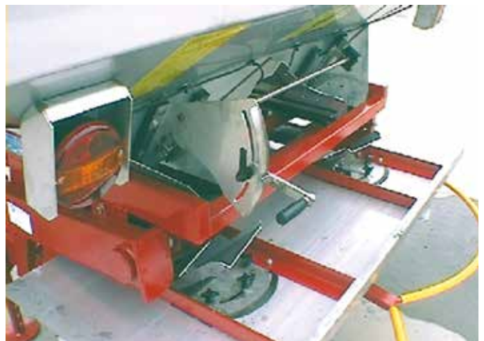
Nedløbene på F2WS og F2S modellerne kan reguleres dynamisk afhængig af doseringsmængden. Erfaringen viser at for at få det mest optimale spredbillede ved forskellige doseringer, er det nødvendigt at justere gødnings nedfaldspunkt på spredetallerkernerne.
