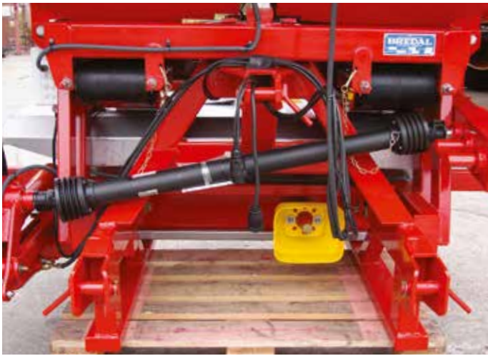
Kraftig rammekonstruktion med justerbart hjultræk der kan justeres til forskellige sporvidder og hjulstørrelser på traktorerne.
