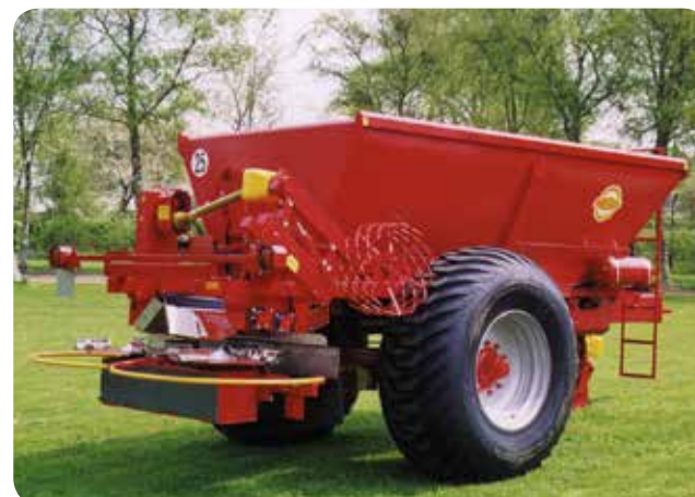
K85 med 650/65 x 30.5 dæk, 12-16 m kalk / 12-24 m gødningsudstyr.
